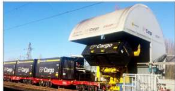
Obrázek č. 105: Překladiště – robotický železniční vykládací systém
